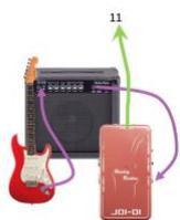
Sobre el cableado de los instrumentos y monitores; tenemos 3 instrumentos con necesidad de caja de inyección (Bajo, y 2 Guitarras) Por tanto utilizamos una caja DI doble y o de las específicas para guitarra eléctrica. El resto de instrumentos al ser puramente electrónicos permiten un acople con la mesa sin perder sonido y van directos (Piano y Batería).
